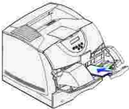
**REMARQUE** : N'essayez pas de charger davantage d'enveloppes en les enfonçant sous le galet presseur d'enveloppes, car vous risqueriez de provoquer des bourrages.
