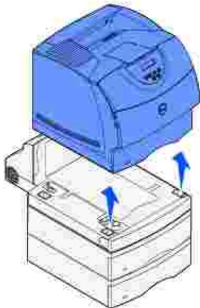
2. Soulevez le bac optionnel avec précaution jusqu'à ce qu'il soit complètement dégagé de l'option du dessous. Mettez-le de côté.
