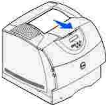
Si le support d'impression n'est pas immédiatement dégagé, relâchez-le aussitôt. Ouvrez la porte supérieure avant et extrayez le support d'impression.
