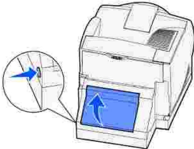
2. Localisez le bord du support d'impression sous la porte arrière du dispositif recto verso afin de déterminer de quel type de bourrage il s'agit :
