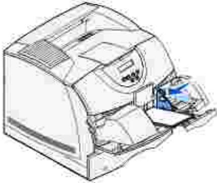
7. Abaissez le galet presseur d'enveloppes de manière à ce qu'il soit en contact avec la pile.
